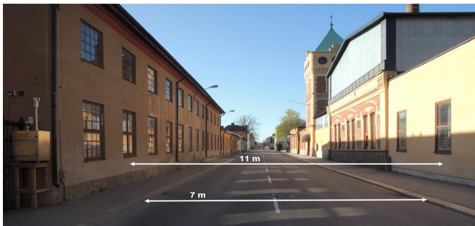
Fig. 3: Mätstationens placering på Glasgatan på kartan (vänster) samt gaturummets utseende i riktning mot NNV. Vägbanan är ca 7 m bred och gaturummet (avstånd mellan byggnader) 11 m. Byggnaden till vänster är ca 10 m hög, byggnaderna till höger mellan 6 och 12 m höga. Trafikvolym (ÅDT) 2500 fordon/dygn, 5.4% tungtrafikandel. Vägbanans beläggning är ABS 16 70/100, vilket gör att parametern hpave i NORTRIP-modellen satts till 2 istället för 1 (beskriver en mjukare typ av asfalt).
