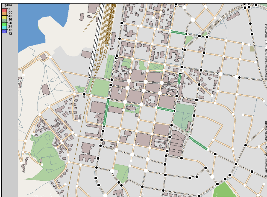
Figur 3 Dagnsmedelvärdet av kvävedioxidhalten i beräkningspunkterna. Inga överskridanden av MKN, ÖUT eller NUT.
